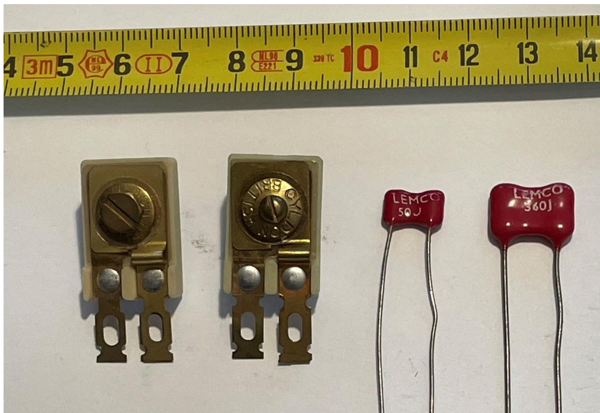
Foto 9.3-3. Twee instelbare micacondensatoren (links) en vaste micacondensatoren (rechts). De schroef in de instelbare condensatoren ('trimmers') brengt de platen naar elkaar toe (hogere capaciteit) of van elkaar af (lagere capaciteit). De roodgekleurde vaste micacondensatoren hebben een waarde van 50 pF en 360 pF.
