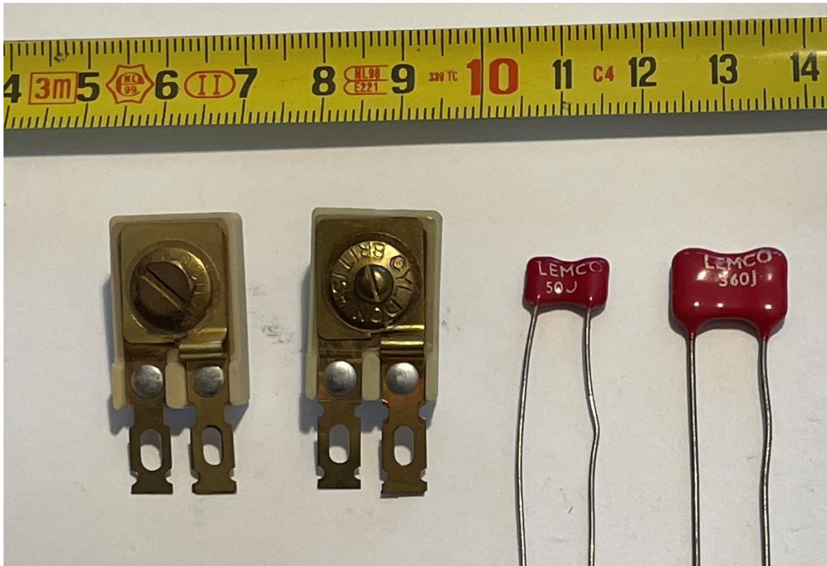
Foto 9.3-3. Twee instelbare micacondensatoren (links) en vaste micacondensatoren (rechts). De schroef in de instelbare condensatoren ('trimmers') brengt de platen naar elkaar toe (hogere capaciteit) of van elkaar af (lagere capaciteit) De roodgekleurde vaste micacondensatoren hebben een waarde van 50 pF en 360 pF.
