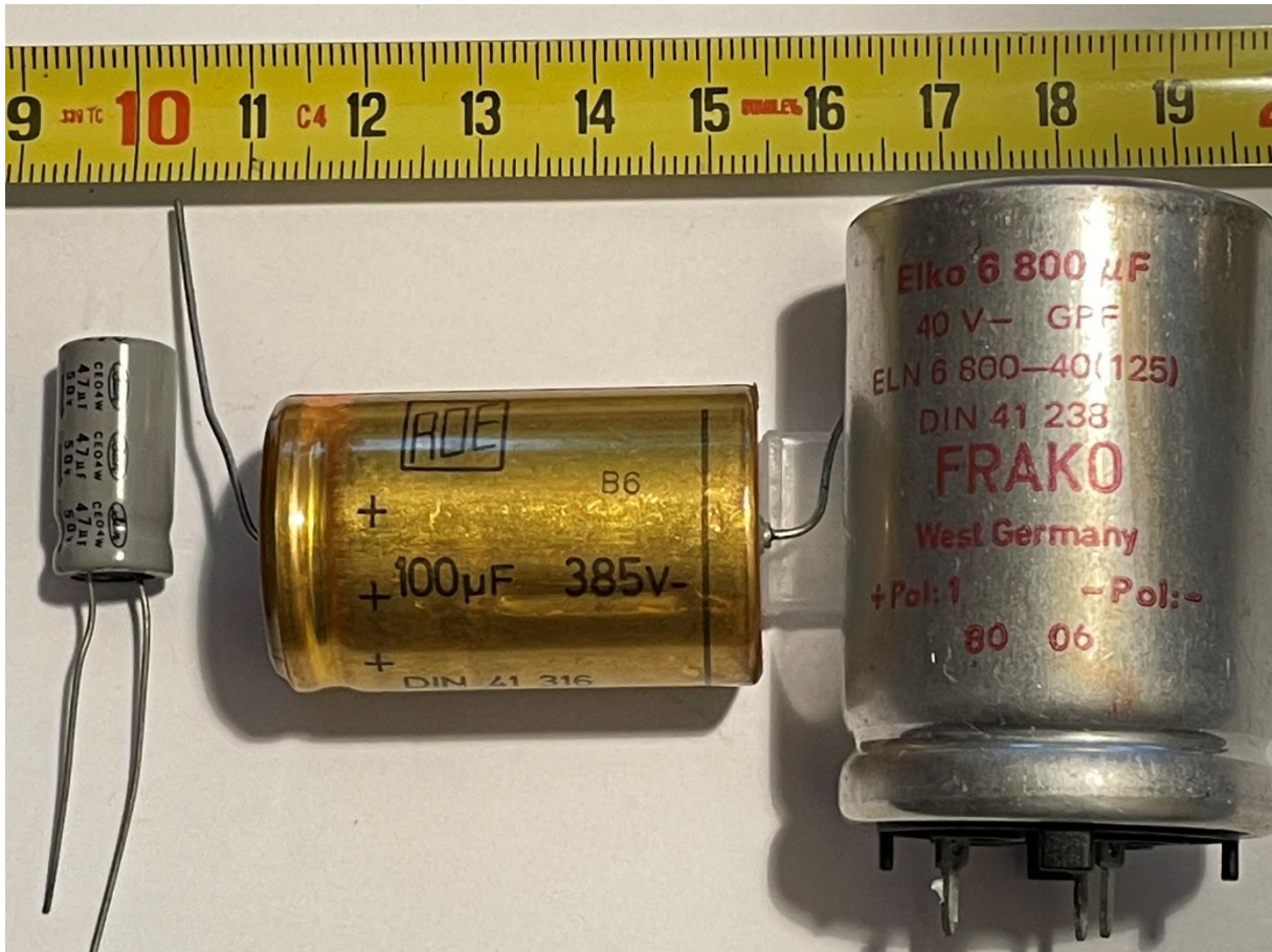
Foto 9.3-6. Drie elco's. Van links naar rechts: 47 \mu\text{F} met een maximale werkspanning van 50 V, 100 \mu\text{F} en 385 V en een grote van 6800 \mu\text{F} met een maximale werkspanning van 40 V.
