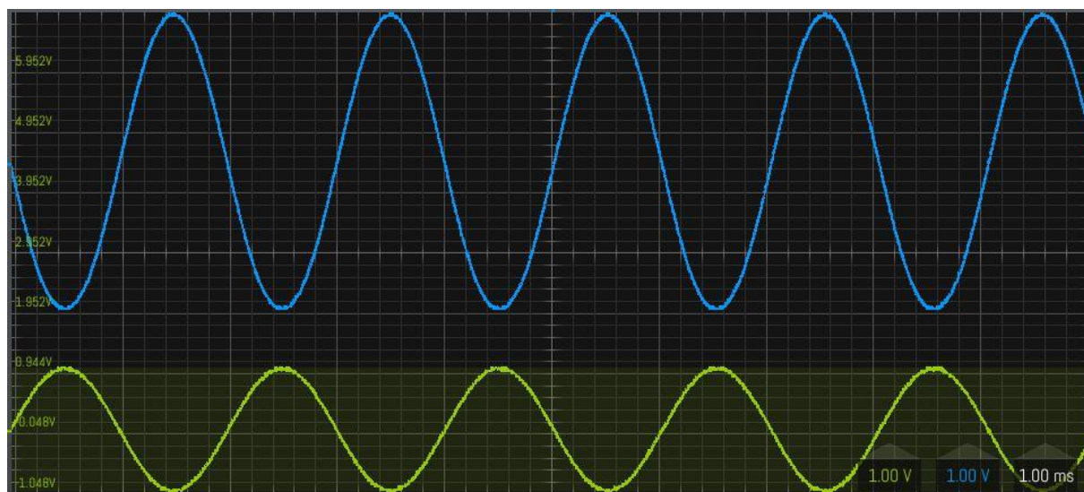
Foto 8.4-1. Oscillogram, gemeten aan de schakeling van Figuur 8.4-5 (links). De foto lijkt op Foto 8.3-1, maar de versterking is iets kleiner. Ook hier zien we tegenfase van in- en uitgangssignaal.
