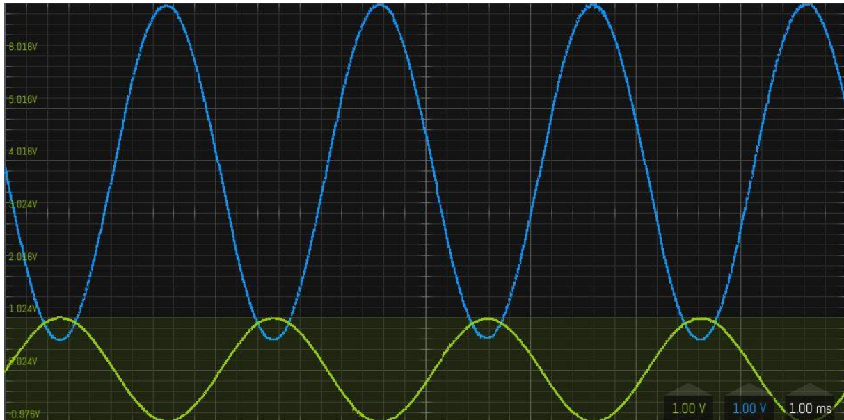
Foto 8.3-1. (Wissel)spanningsversterking door een transistorversterker met een collectorweerstand van 3,3 k \Omega en een emitterweerstand van 1 k \Omega . De gele sinus komt binnen op de basis, de blauwe is de wisselspanning op de collector. De amplitudeverhouding is net geen 1:3,3. De twee sinussen zijn in tegenfase: maxima bij de één vallen samen met minima bij de ander.
