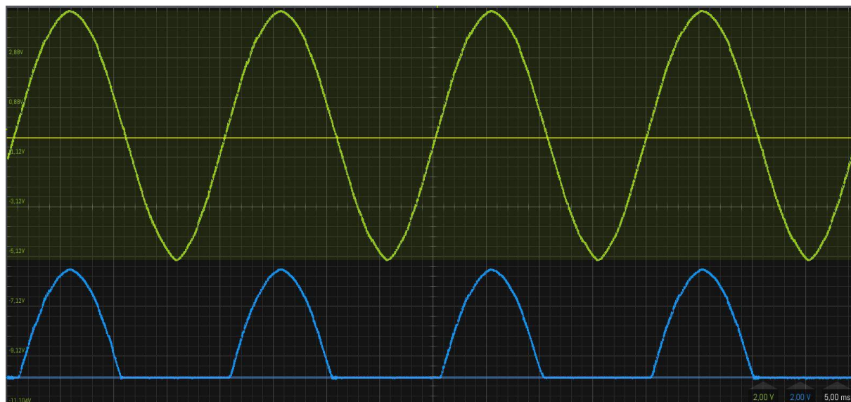
Foto 7.4-1 (bewerkt). Sinusvormige wisselspanning (geel). Frequentie: 50 Hz, de lichtnetfrequentie. Daaronder in blauw de enkelzijdig gelijkgerichte spanning. De nullijnen zijn uitgevoerd in de kleur van de bijbehorende grafiek. Bij de sinus in het midden, bij de gelijkgerichte spanning onder tegen de grafiek.
