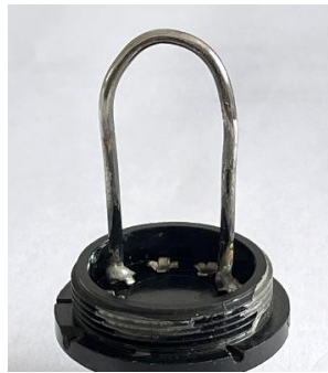
Foto 6.3-1. Spoel met een wikkeling van minder dan één winding.
