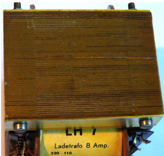
Foto 6.3-3. Links een trafo voor aanzienlijk meer vermogen dan die op Foto 6.3-2. Rechts een close-up van de bovenkant, waar de lamellen van de ijzerkern te zien zijn.
