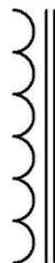
Figuur 6.6-1. Schemasymbool van een smoorspoel met ijzerkern. Het lijkt op een halve trafo en eigenlijk is het dat ook.
