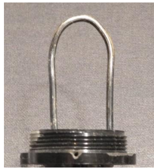
Foto 6.3-1. Spoel met een wikkeling van minder dan één winding.
