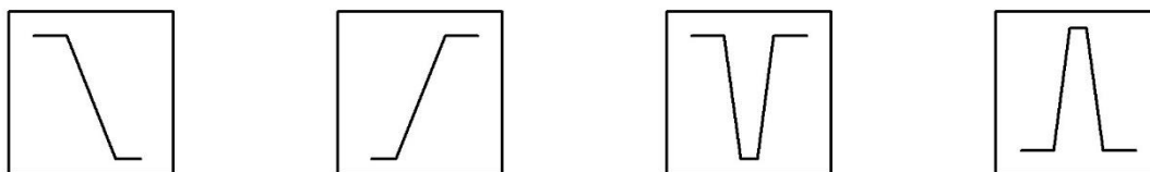
Figuur 5.6-1. Schemasymbolen en gebruikelijke afkortingen voor verschillende soorten frequentiefilters in twee variaties. De bijbehorende namen staan in het midden, Cursief: de Engelse termen.
