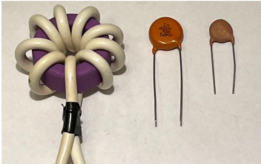
Foto 16.4-2. Van links naar rechts: ferriet-ringkern bewikkeld met netsnoer, keramische condensator van 1 nF, max. 7,5 kV, keramische condensator van 2,2 nF, max. 3 kV. Wegens de lagere doorslagspanning en daarom dunner diëlektricum is de 2,2 nF kleiner dan die van 1 nF. Voor 230 V netspanning is 1 kV ruim voldoende.
