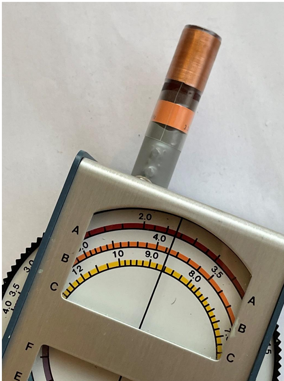
Foto 15.4-2. Detail van de dipper van Foto 15.4-1, nu met gemonteerde spoel.
