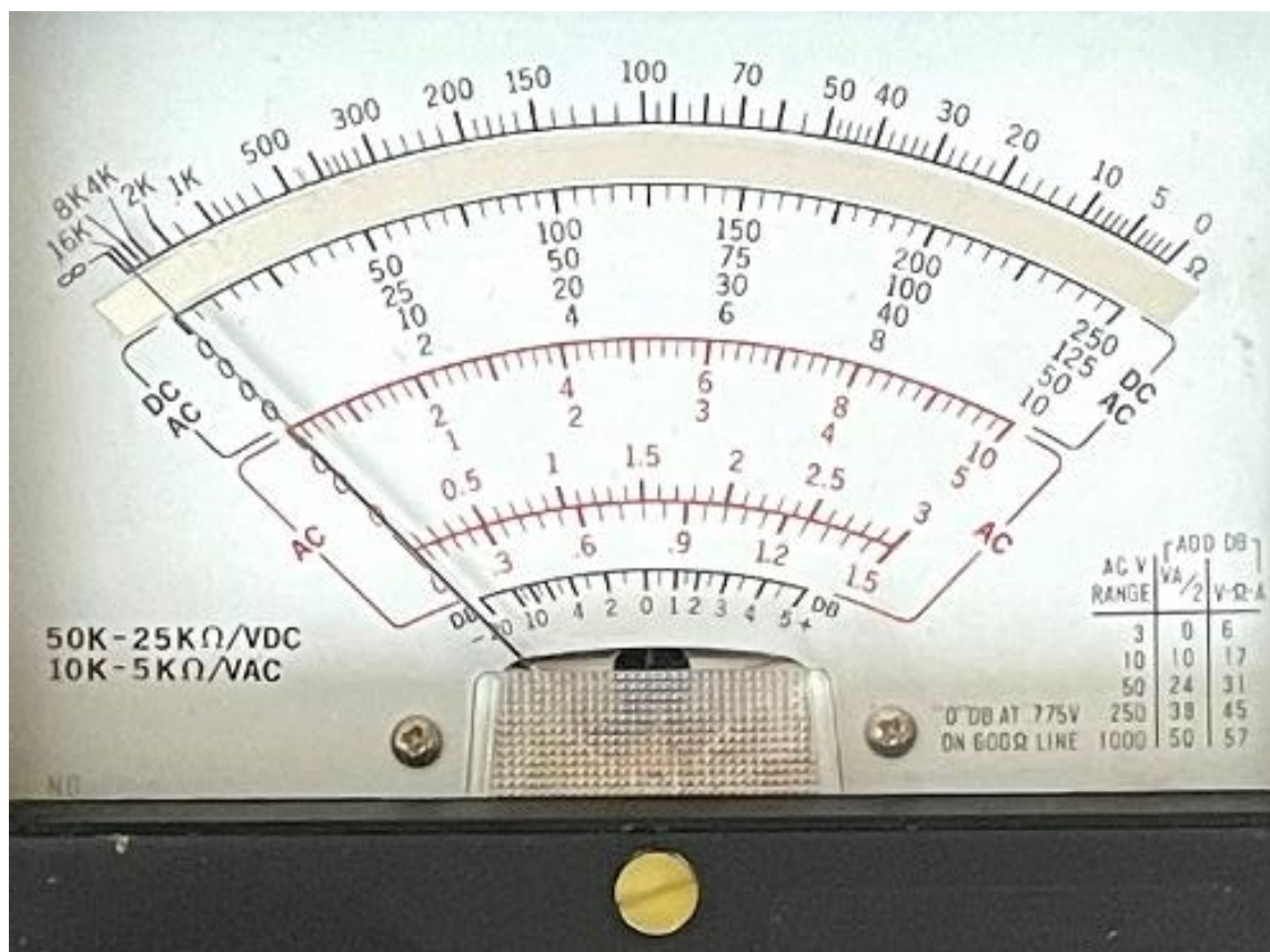
Foto 15.3-2. De afleesschaal van de multimeter van Foto 15.3-1 vergroot. De bovenste is de weerstandsschaal (zie \Omega -teken rechts).
