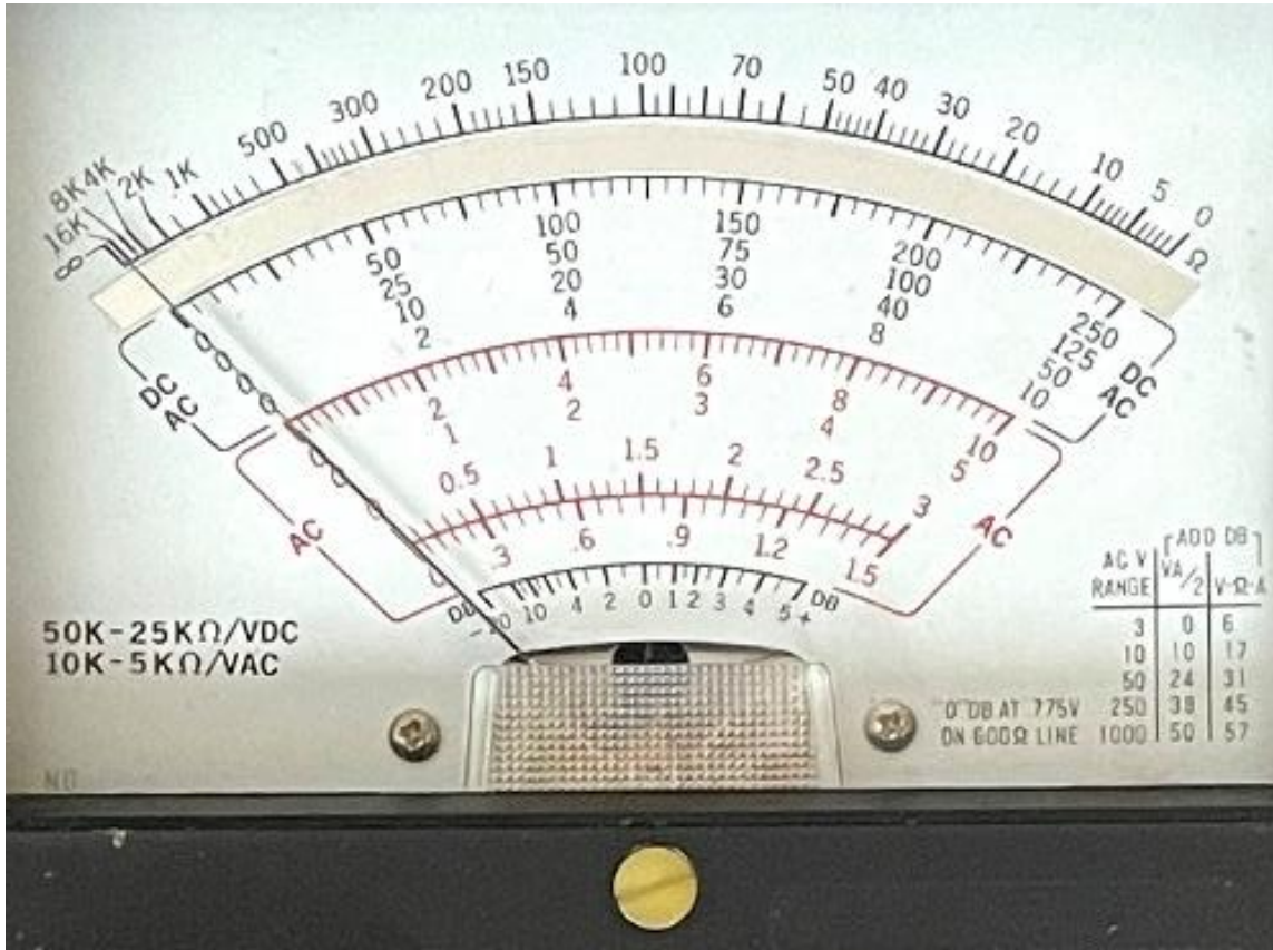
Foto 15.3-2. De afleesschaal van de multimeter van Foto 15.3-1 vergroot. De bovenste is de weerstandsschaal.
