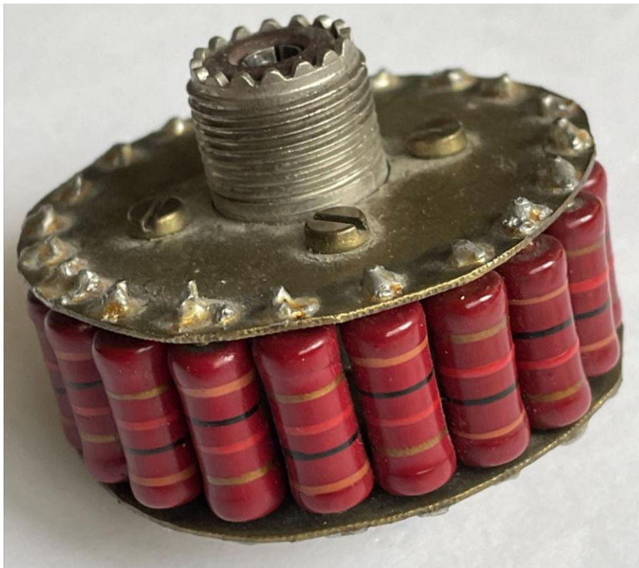
Foto 15.7-1. Zelfbouw-kunstantenne (dummy load)
