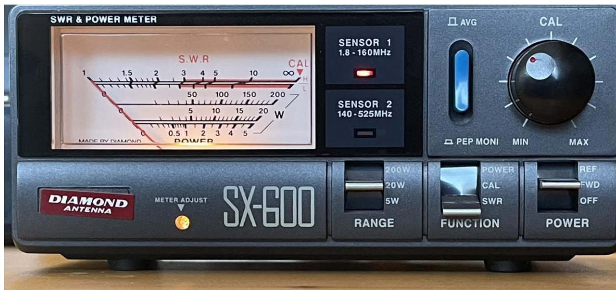
Foto 15.6-2. SWR-meter met meer mogelijkheden dan het apparaat van Foto 15.6-1.
