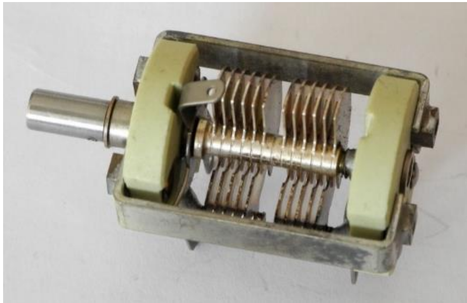
Foto 13.2-1. Een dubbele afstemcondensator kan er zo uitzien. De twee condensatoren zijn mechanisch gekoppeld via de as. Omdat daar een bedieningsknop op zit, wordt de rotor (het draaiende deel) altijd met massa (aarde) verbonden. Dat voorkomt verstemming door capacitief handcontact. Dit exemplaar is vrij klein ( 2 \times 35 \text{ pF} ); voor midden- en lange golf heb je al gauw 2 \times 500 \text{ pF} nodig.
