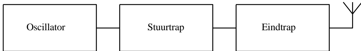
Figuur 12.3-3. Blokschema van een zender die bestaat uit een oscillator, een eindtrap en een stuurtrap ertussen
