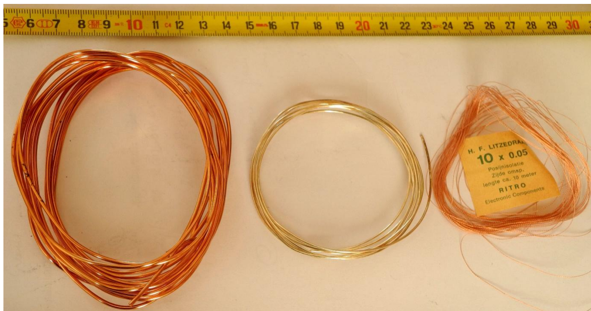
Foto 6.10-1. Drie voorbeelden van wikkeldraad. Van links naar rechts: koperdraad met isolatie van heldere lak ("lakdraad"); verzilverd koperdraad en koperlitze: elk draadje, omwikkeld met heel dunne zijde bestaat uit 10 draadjes met zg. posijnisolatie. Posijn laat zich met een hete soldeerbout gemakkelijk vertinnen, in tegenstelling tot de lak van het lakdraad, dat je eerst moet afkrabben. Verzilverd draad is meestal lakloos. Ruimte tussen de windingen is dan nodig om geen sluiting tussen de windingen te krijgen.
