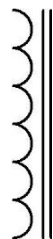
Figuur 6.8-1. Schemasymbool van een smoorspoel met ijzerkern. Het lijkt op een halve trafo en eigenlijk is het dat ook.
