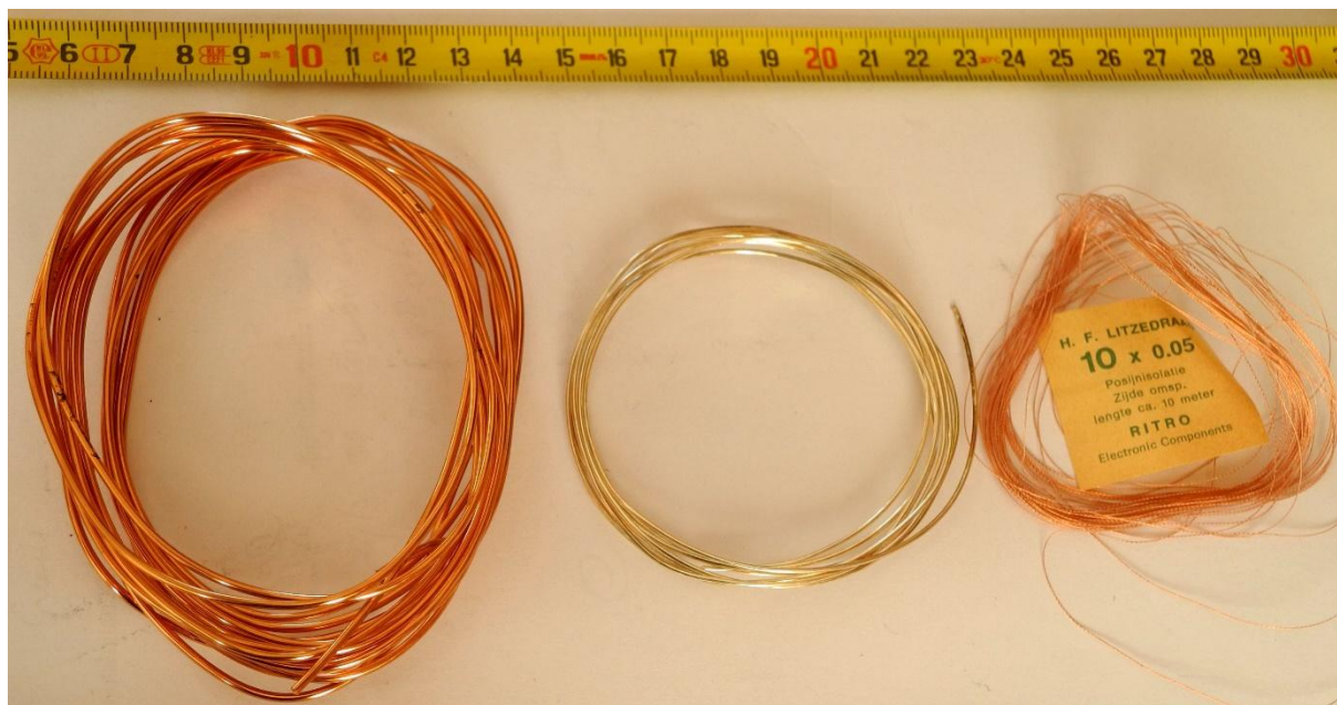
Foto 6.10-1. Drie voorbeelden van wikkeldraad. Van links naar rechts: koperdraad met isolatie van heldere lak ("lakdraad"); verzilverd koperdraad en koperlitz: elk draadje, omwikkeld met heel dunne zijde bestaat uit 10 draadjes met zg. posijnisoliatie. Posijn laat zich met een hete soldeerbout gemakkelijk vertinnen, in tegenstelling tot de lak van het lakdraad, dat je eerst moet afkrabben. Verzilverd draad is meestal lakloos. Ruimte tussen de windingen is dan nodig om geen sluiting tussen de windingen te krijgen.
