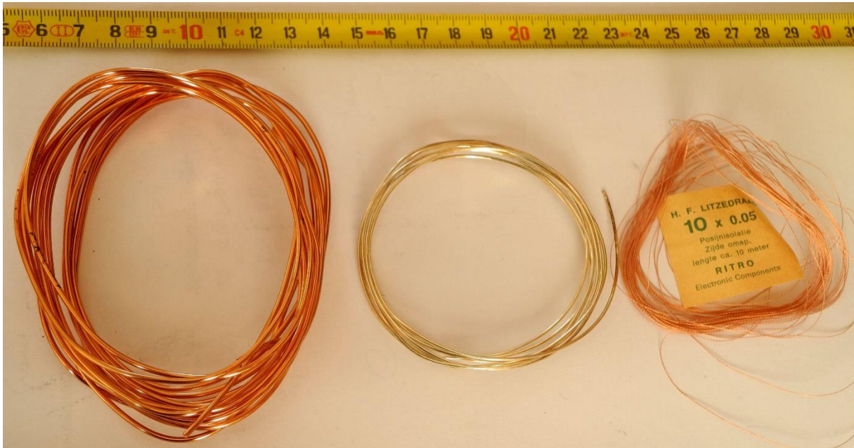
Foto 6.10-1. Drie voorbeelden van wikkeldraad. Van links naar rechts: koperdraad met isolatie van heldere lak ("lakdraad"); verzilverd koperdraad en koperlitz: elk draadje, omwikkeld met heel dunne zijde bestaat uit 10 draadjes met zg. posijnisolatie. Posijn laat zich met een hete soldeerbout gemakkelijk vertinnen, in tegenstelling tot de lak van het lakdraad, dat je eerst moet afkrabben. Verzilverd draad is meestal lakloos. Ruimte tussen de windingen is dan nodig om geen sluiting tussen de windingen te krijgen.
