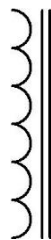
Figuur 6.8-1. Schemasymbool van een smoorspoel met ijzerkern. Het lijkt op een halve trafo en eigenlijk is het dat ook.
