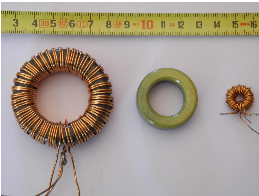
Foto 6.10-4. Ringkernen: poederijzer/carbonyl; Links een kern, bewikkeld als transformator (“balun”; meer hierover in het hoofdstuk over antennes). Midden een onbewikkelde kern. De kleur geeft het frequentiegebied aan, in dit geval 12-50 MHz. Rechts een kleine kern, 1:4 bewikkeld.
