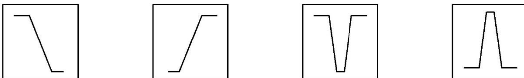
Figuur 5.7-1. De vier soorten frequentiefilters. Cursief: de Engelse termen.
