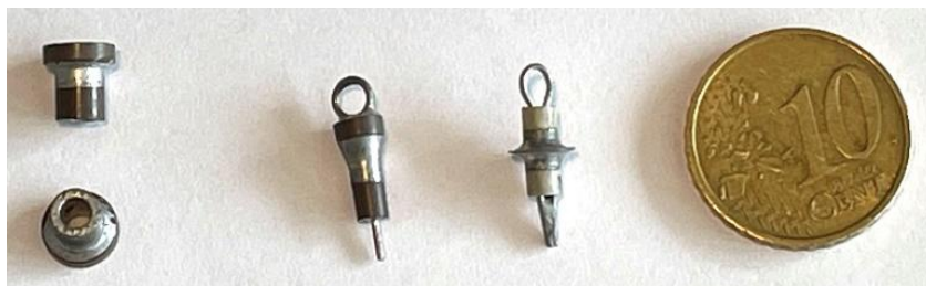
Foto 16.4-4. Doorvoercondensatoren met verschillende manieren van monteren. Links: leiding moet in de condensator worden gesoldeerd; midden: taps toelopende buitenkant met doorvoer (oogje en draadeind); rechts: met soldeerflens en doorvoer (oogje en draadeind).
