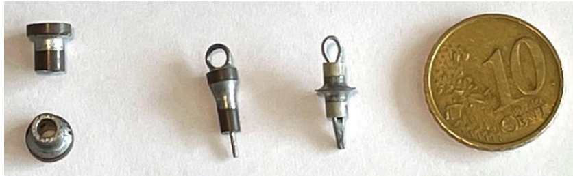
Foto 16.4-4. Doorvoercondensatoren met verschillende manieren van monteren. Links: leiding moet in de condensator worden gesoldeerd; midden: taps toelopende buitenkant met doorvoer (oogje en draadeind); rechts: met soldeerflens en doorvoer (oogje en draadeind).
