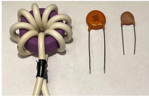
Foto 16.4-2. Van links naar rechts: ferriet-ringkern, bewikkeld met netsnoer, keramische condensator van 1 nF, 7,5 kV, keramische condensator van 2,2 nF, 3 kV. Door de lagere doorslagspanning en daarom dunner diëlektricum is de 2,2 nF kleiner dan die van 1 nF. Voor 230 V netspanning is 1 kV ruim voldoende.
