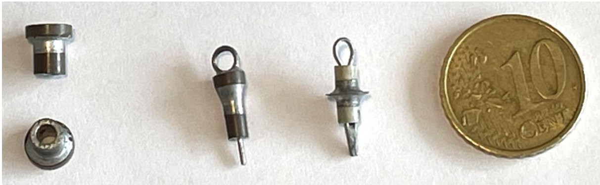
Foto 16.4-4. Doorvoercondensatoren met verschillende manieren van monteren. Links: leiding moet in de condensator worden gesoldeerd; midden: taps toelopen buitenkant met doorvoer (oogje en draadeind); rechts: met soldeerflens en doorvoer (oogje en draadeind).
