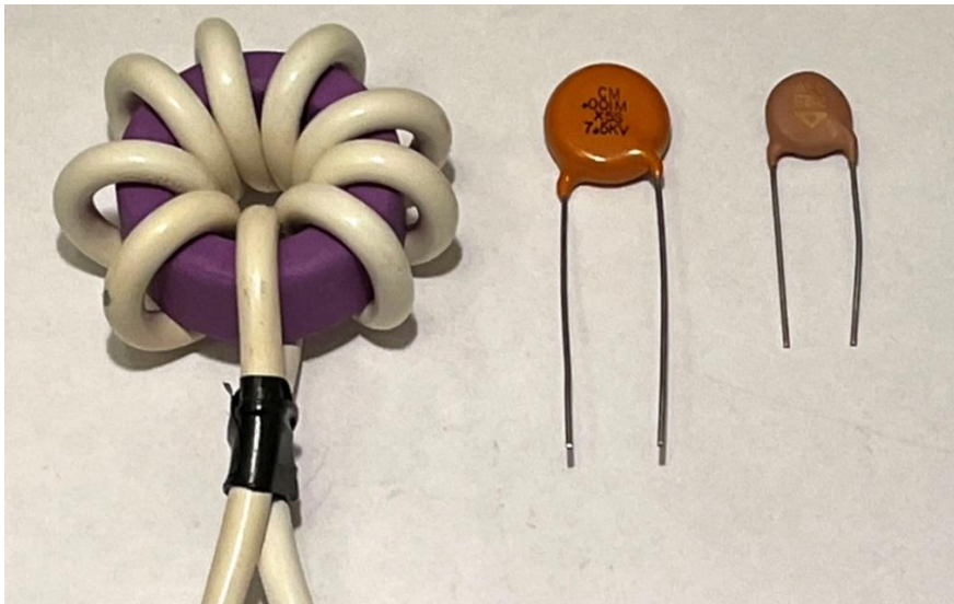
Foto 16.4-2. Van links naar rechts: ferriet-ringkern bewikkeld met netsnoer, keramische condensator van 1 nF, max. 7,5 kV, keramische condensator van 2,2 nF, max. 3 kV. Wegens de lagere doorslagspanning en daarom dunner diëlektricum is de 2,2 nF kleiner dan die van 1 nF. Voor 240 V netspanning is 1 kV ruim voldoende.
