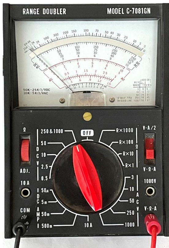
Foto 15.3-1. Een analoge universeelmeter uit 1976. De meter is geschikt voor gelijk- en wisselspanning, gelijkstroom en weerstand.
