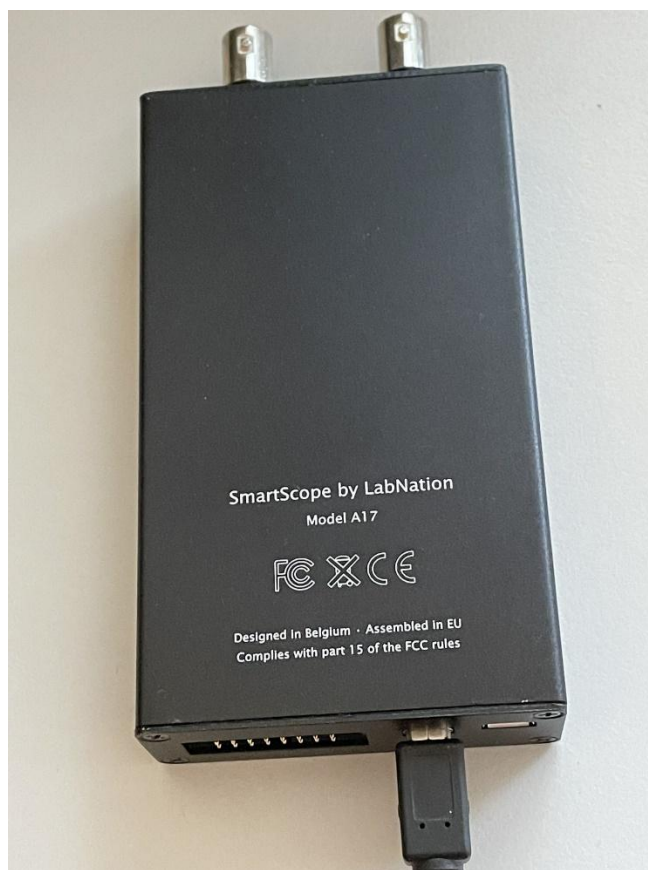
Foto 15.4-2. Digitale oscilloscoopmodule. Boven: twee BNC-signaalingangen; rechtsonder de USB-aansluitingen; linksonder de aansluiting voor een logic analyzer.
