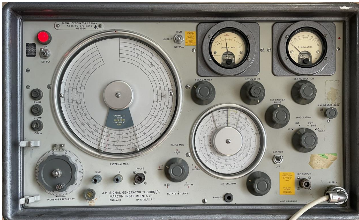
Foto 15.8-1. Marconi meetzender. Een met buizen uitgevoerd (loodzwaar) precisie-instrument uit 1966.
