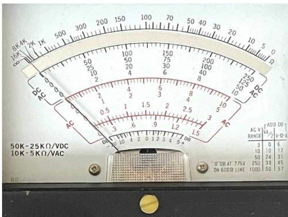
Foto 15.3-2. De afleesschaal van de universeelmeter van Foto 15.3-1 vergroot. De bovenste is de weerstandsschaal.
