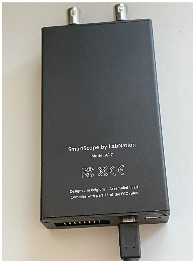
Foto 15.4-2. Digitale oscilloscoopmodule. Boven: twee BNC-sigaaalingangen; rechtsonder de USB-aansluitingen; linksonder de aansluiting voor een logic analyzer. Veel foto's in deze cursus zijn met behulp van dit apparaatje gemaakt. Voorbeeld is Foto 15.4-3 (volgende bladzijde)
