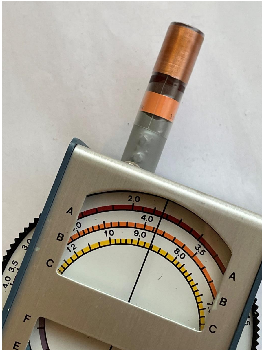
Foto 15.6-2. Detail van de dipper van Foto 15.6-1, nu met gemonteerde spoel.
