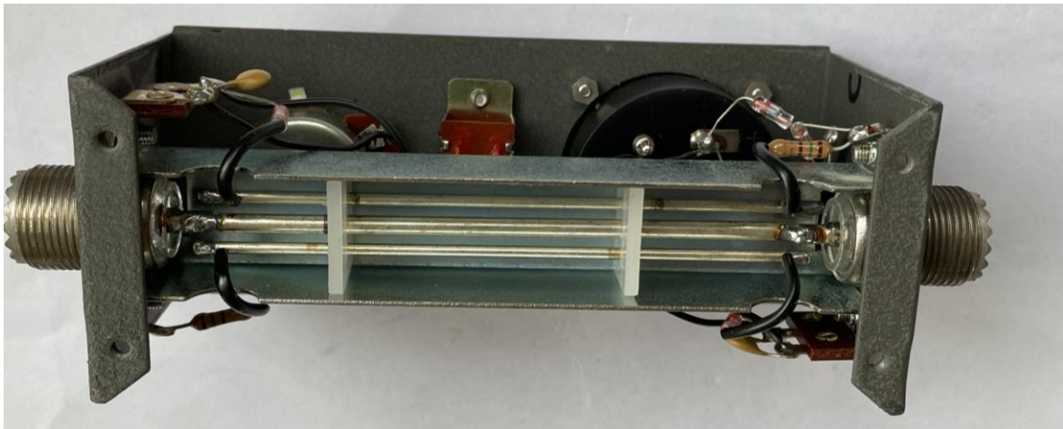
Foto 15.9-1. Binnenader met koppelstukjes in een SWR-meter. Links en rechts de kabelaan sluitingen. Het metalen gootje verbindt de mantels; de middelste zilverkleurige leiding tussen de aansluitingen verbindt de binnenaders. Aan weerskanten van het binnenaderstuk de eveneens zilverkleurige koppelstukjes.
