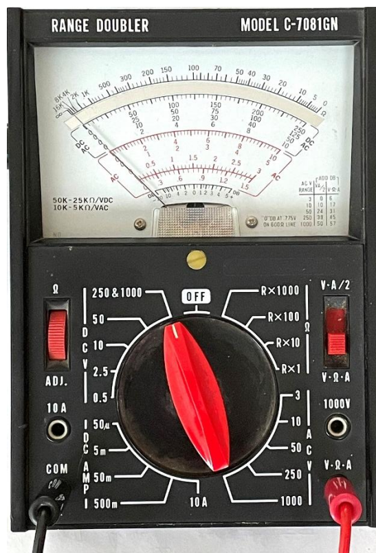
Foto 15.3-1. Voorbeeld van een analoge universeelmeter uit 1976. Het apparaat meet gelijk- en wisselspanning, gelijkstroom en weerstand.
