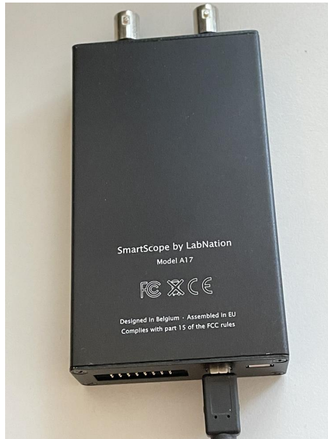
Foto 15.4-2. Digitale oscilloscoopmodule. Boven: twee BNC-signaalingangen; rechtsonder de USB-aansluitingen; linksonder de aansluiting voor een logic analyzer. Veel foto's in deze cursus zijn met behulp van dit apparaatje gemaakt. Voorbeeld is Foto 15.4-3 (volgende bladzijde)
