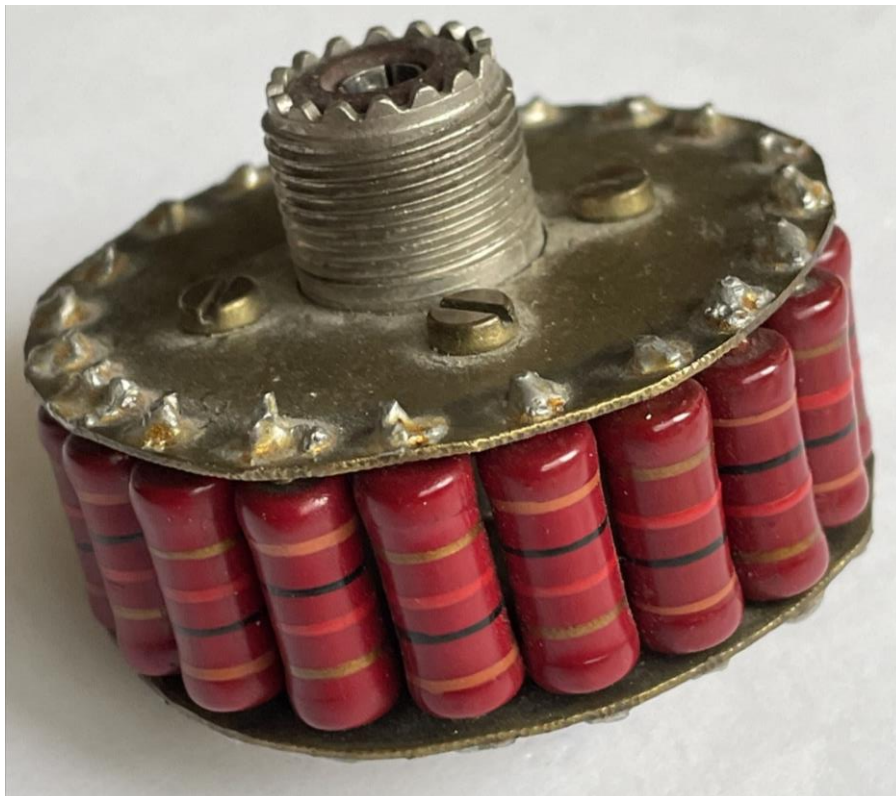
Foto 15.10-1. Zelfbouw-kunstantenne (dummy load)
