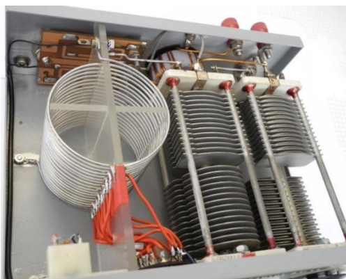
Foto 14.2-2. Het binnenste van een antennetuner met geschakelde spoel. Rechts twee variabele condensatoren. Achter links: printje voor SWR-meter, midden achter: bifilair op ferriet ringkern gewikkelde balun voor aanpassing naar symmetrische lijn. Bouwer: wijlen Henny Schoeman, PA3AKQ.
