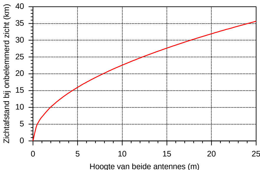
Figuur 14.3-1. Lengte van een zichtverbinding als functie van de antennehoogte bij even hoge antennes.
