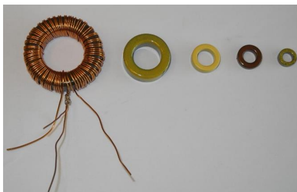
Foto 14.2-1. Voorbeelden van ringkernen. De kleur geeft het meest passende frequentiegebied aan. De grootte heeft te maken met het maximale vermogen dat de kern aan kan. Links een bewikkelde kern.
