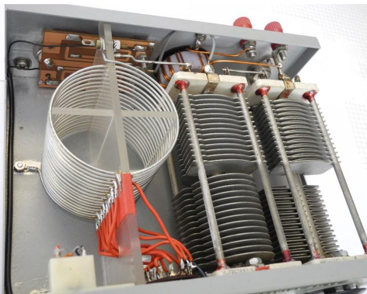
Foto 14.3-2. Het binnenste van een antennetuner met geschakelde spoel. Rechts twee variabele condensatoren. Achter links: printje voor de SWR-meter, midden achter: bifilaire op ferriet ringkern gewikkelde balun voor aanpassing naar symmetrische lijn. Bouwer: wijlen Henny Schoeman, PA3AKQ.
