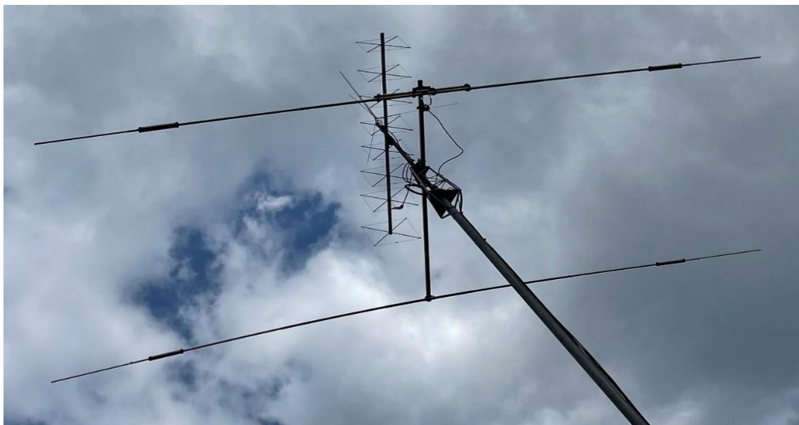
Foto 14.5-1. Voorbeeld van een antenne-opstelling. De grote antenne heeft ogenschijnlijk traps voor één extra frequentie, in werkelijkheid voor twee (zie tekst). Erboven een quad voor 144-146 MHz (met de gekruiste draadhouders); daarboven een verticale antenne voor drie banden zonder zichtbare traps; de meerbandenconstructie zit binnenin de buis. De kooiachtige constructie onder de antennes bevat een rotor om de antennes in alle richtingen te kunnen draaien.
