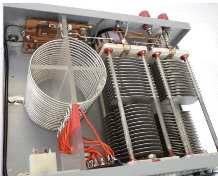
Foto 14.3-2. Het binnenste van een antennetuner met geschakelde spoel. Rechts twee variabele condensatoren. Achter links: printje voor de SWR-meter, midden achter: bifilair op ferriet ringkern gewikkelde balun voor aanpassing naar symmetrische lijn. Bouwer: wijlen Henny Schoeman, PA3AKQ.
