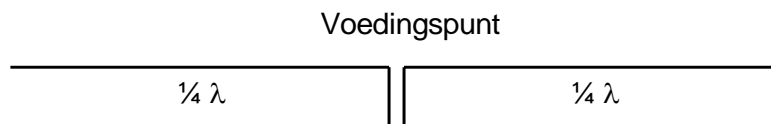
Figuur 14.3-7 Dipoolantenne bestaande uit twee helften van \frac{1}{4} golf lang. Het voedingspunt met lage impedantie zit in het midden.
