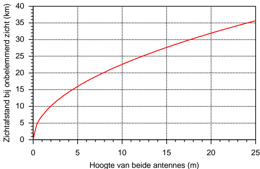
Figuur 14.4-2. Lengte van een zichtverbinding als functie van de antennehoogte bij even hoge antennes.
