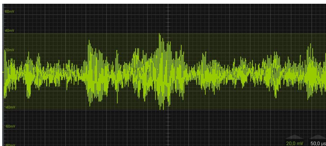
Foto 13.2-2. Oscilloscoopbeeld van ruis. Klik erop en er komt een bewegend beeld en het geluid van ruis. Schaal verticaal: 20 mV per schaaldeel, horizontaal 50 \mu\text{s} per schaaldeel.
