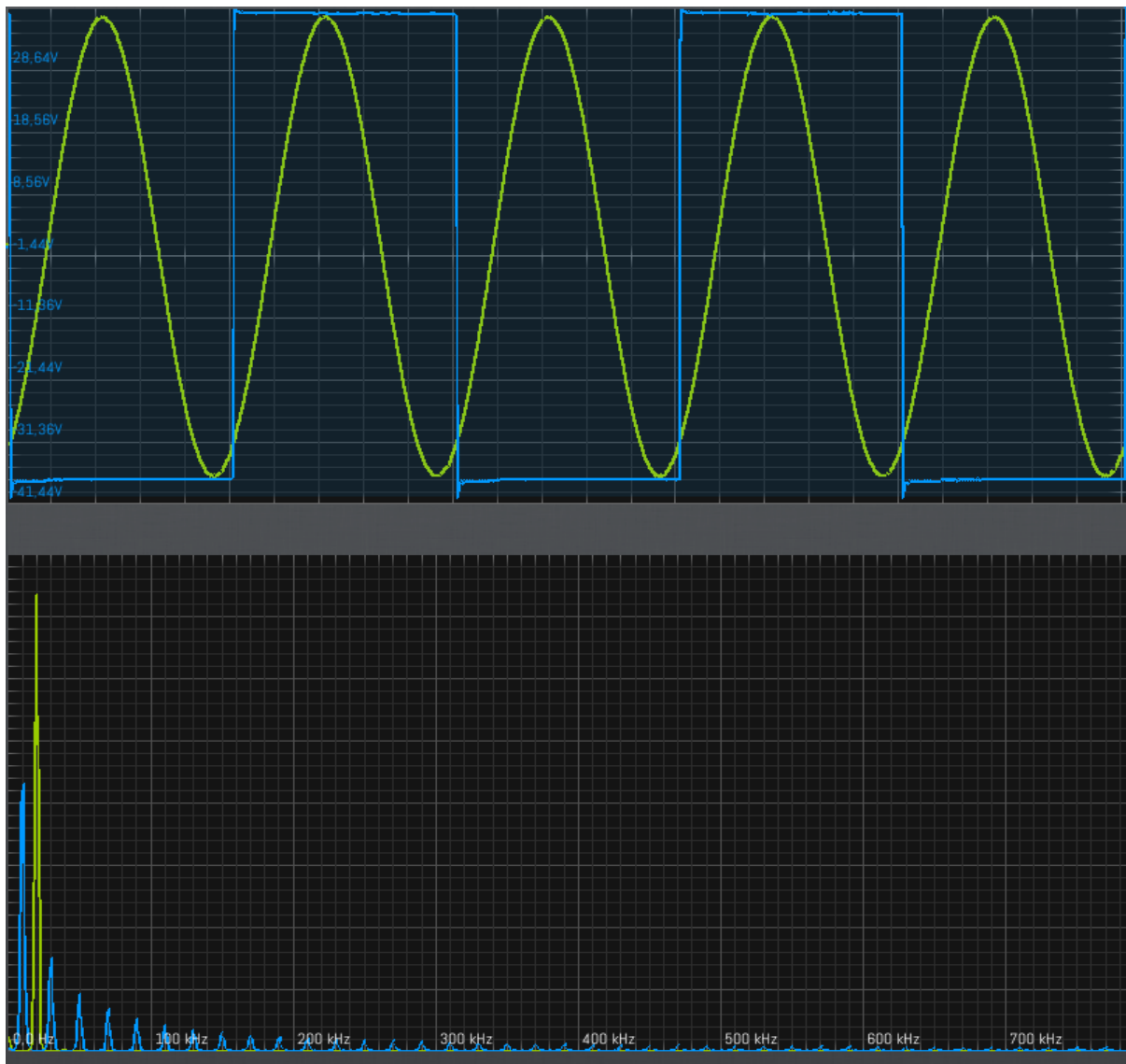
Foto 13.7-1. Sinusspanning (20 kHz, geel ), blokspanning (10 kHz, blauw ) boven en hun frequentiespectra (onder).
