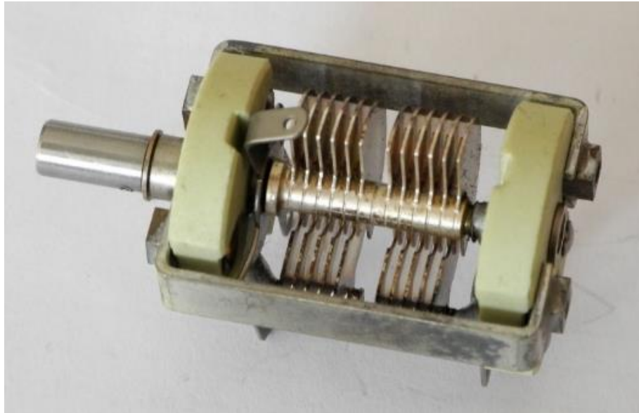
Foto 13.2-1. Een dubbele afstemcondensator kan er zo uitzien. De twee condensatoren zijn mechanisch gekoppeld via de as. Omdat daar een bedieningsknop op zit, wordt de rotor (het draaiende deel) altijd met massa (aarde) verbonden. Dat voorkomt verstemming door capacitief handcontact. Dit exemplaar is vrij klein (2x35 pF); voor midden- en lange golf heb je al gauw 2x 500 pF nodig.
