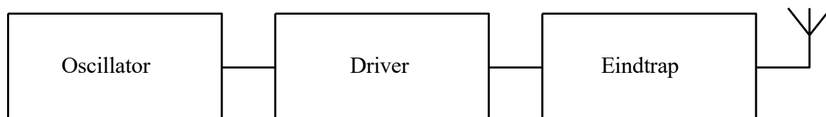
Figuur 12.4-3. Blokschema van een zender die bestaat uit een oscillator, een eindtrap en een drivertrap ertussen.
