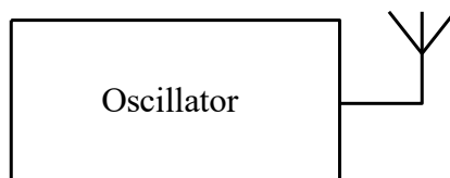
Figuur 12.4-1. Blokschema van een zender die alleen bestaat uit een oscillator.
