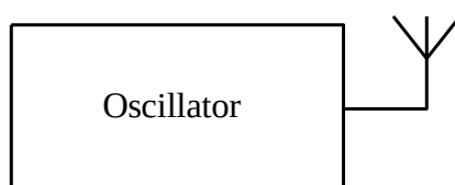
Figuur 12.4-1. Blokschema van een zender die alleen bestaat uit een oscillator.
