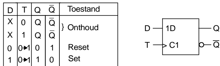
Figuur 12.3-12 Flank gestuurde D-flipflop.
