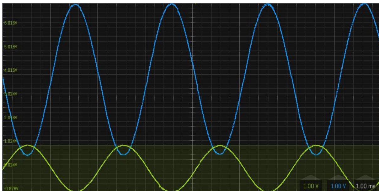
Foto 8.7-1. Oscillogram van in- en output van de schakeling van Figuur 8.7-13. Input: gele sinus; output: blauwe sinus. Frequentie: 500 Hz.
