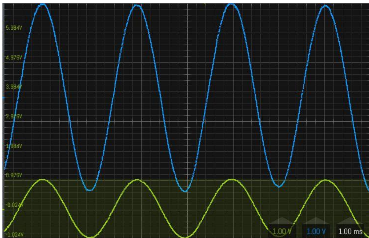
Foto 8.7-2. Oscillogram van in- en output van de schakeling van Figuur 8.7-14. Input: gele sinus; output: blauwe sinus. Frequentie: 500 Hz.
