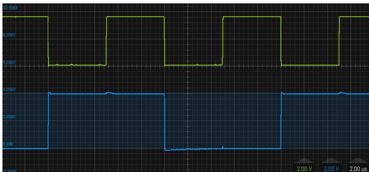
Foto 11.6-1. Frequentiedeling met een JK-flipflop bij J=1 en K=1 . Geel: klok. Blauw: Spanning op uitgang Q .
