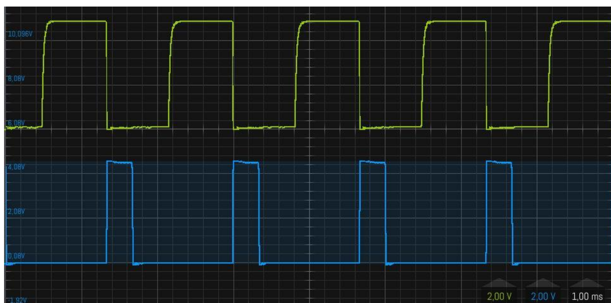
Foto 11.7-1. Geel (boven): spanning op de uitvoer van het astabiele deel en invoer van het monostabiele deel (Osc. 1 in Figuur 11.7-3. Blauw (onder): uitvoer van het monostabiele deel (Osc. 2 in Figuur 11.7-3).
