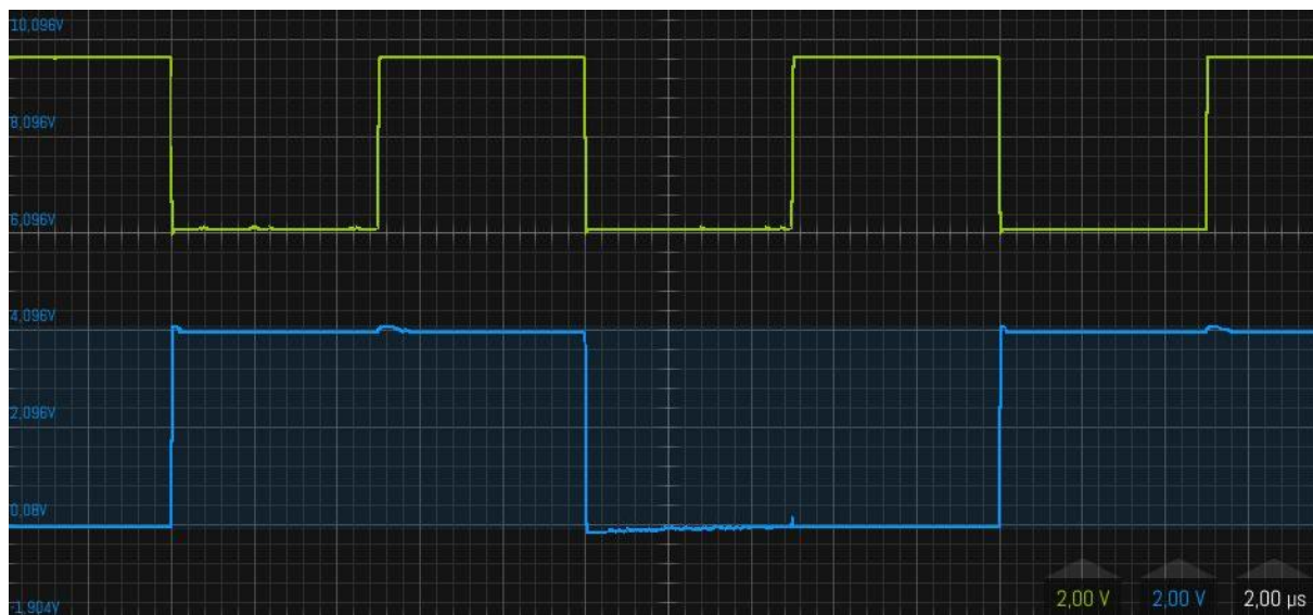
Foto 11.7-2. Frequentiedeling met een JK-flipflop bij J=1 en K=1 . Geel: klok. Blauw: Spanning op uitgang Q .
