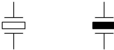
Figuur 10.6-1. Schemasymbool van een kwartskristal. In deze cursus gebruiken we het symbool links (met open rechthoek). In andere teksten kun je ook het rechter symbool (met zwarte rechthoek) tegenkomen.
